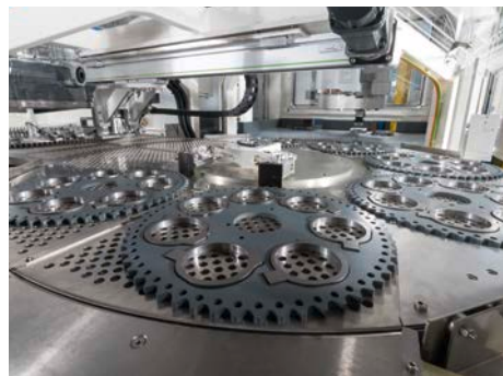
Blick in den Twin Loader – für kürzesten Läufer Scheibenaustausch
